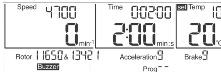
Abb. 17: Einstellen der Solltemperatur
