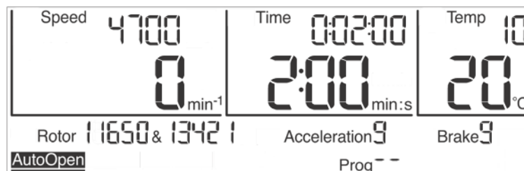
Abb. 21: Die automatische Deckelöffnung "Auto Open" ist aktiviert
