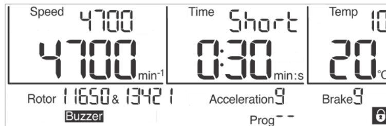
Abb. 16: Anzeige "Short" während des Kurzzeitbetriebs
