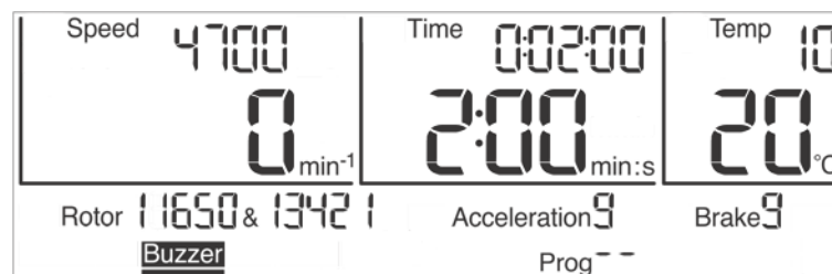
Abb. 22: Das akustische Signal "Buzzer" ist aktiviert
