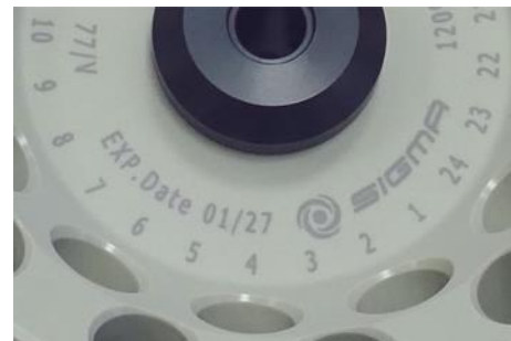
Abb. 4: abweichende Lebensdauer – Gravur auf dem Becher / Rotor
