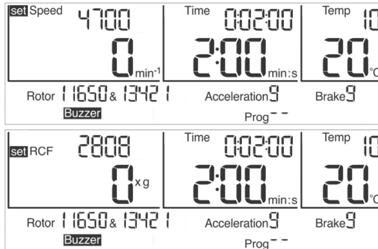
Abb. 12: Einstellen des Drehzahlwertes oder des RZB-Wertes
