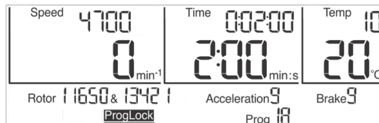
Abb. 23: Die Programmsperre "ProgLock" ist aktiviert
