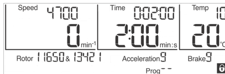
Abb. 26: Symbol "Vorhängeschloss" bei aktivierter Eingabesperre
