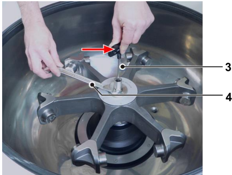
Abb. 20: "Zwei-Finger-Prinzip" beim Halten des Innensechskantschlüssels
