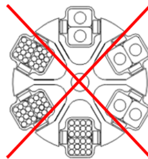
Abb. 22: Zulässige und unzulässige Beladung eines Ausschwingrotors mit unterschiedlichen Gläsergrößen (Beispiel)
