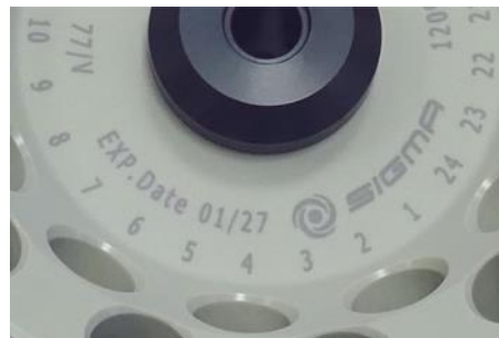
Abb. 8: abweichende Lebensdauer – Gravur auf dem Becher / Rotor
