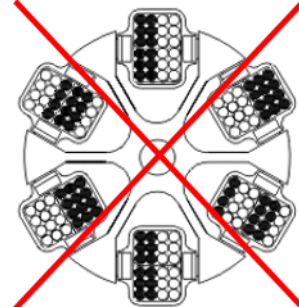
Abb. 23: Zulässige und unzulässige Beladung von Winkel- und Ausschwingrotoren (Beispiele)
