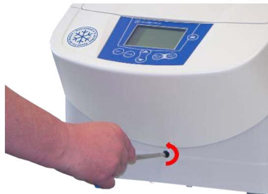
Abb. 10: Manuelle Entriegelung des Deckelschlosses
