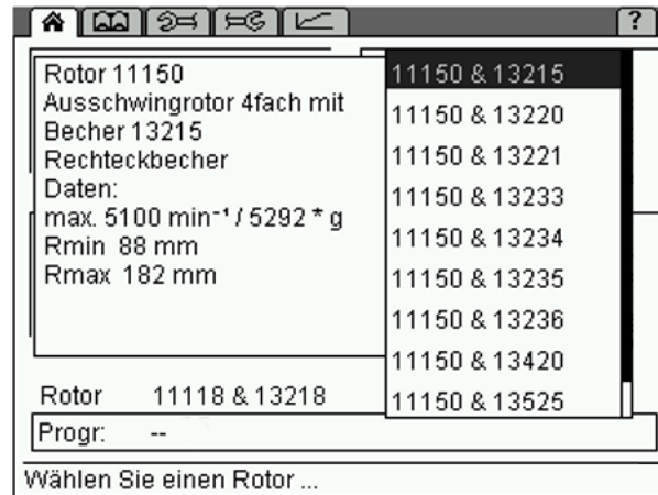
Abb. 15: Rotorauswahlliste, hier für einen Ausschwingrotor
