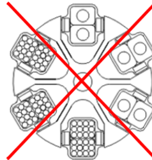
Abb. 8: Zulässige und unzulässige Beladung des Ausschwingrotors mit unterschiedlichen Gläsergrößen (Beispiele)
