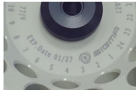
Abb. 5: abweichende Lebensdauer – Gravur auf dem Becher / Rotor
