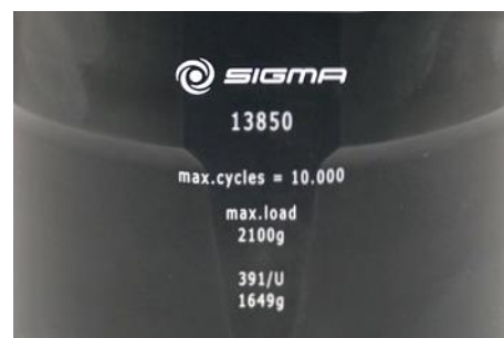
Abb. 5: abweichende Lebensdauer – Gravur auf dem Becher / Rotor
