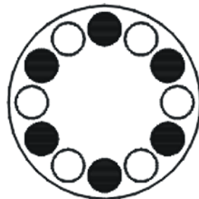
Abb. 5: Zulässige und unzulässige Beladung eines Winkelrotors (Beispiel)
