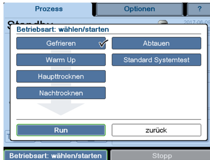
Abb. 29: Dialogfenster "Betriebsart wählen / starten" (Anzeige variiert je nach Ausstattung der Gefriertrocknungsanlage)
