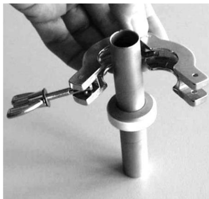
Abb. 56: Ansetzen des Spannrings
