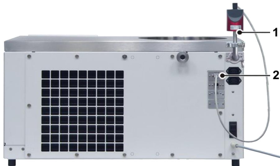
Abb. 11: Position der Vakuummesssonde und der Anschlussbuchse
