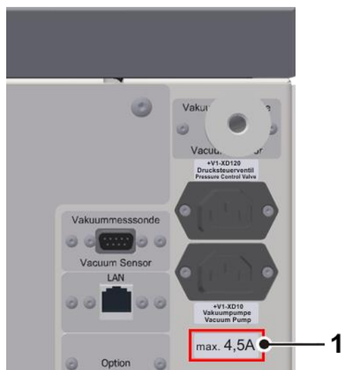
Abb. 13: Angabe des Maximalstroms für die Vakuumpumpe (Beispiel)
