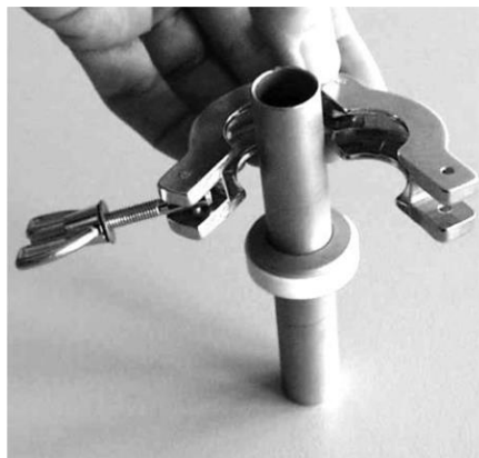
Abb. 67: Ansetzen des Spannrings
