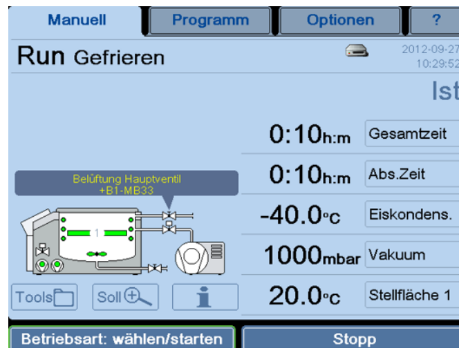
Abb. 23: Darstellung eines Anlagenschemas mit Bezeichnung und Betriebsmittelkennzeichen
