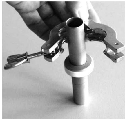
Abb. 54: Ansetzen des Spannrings
