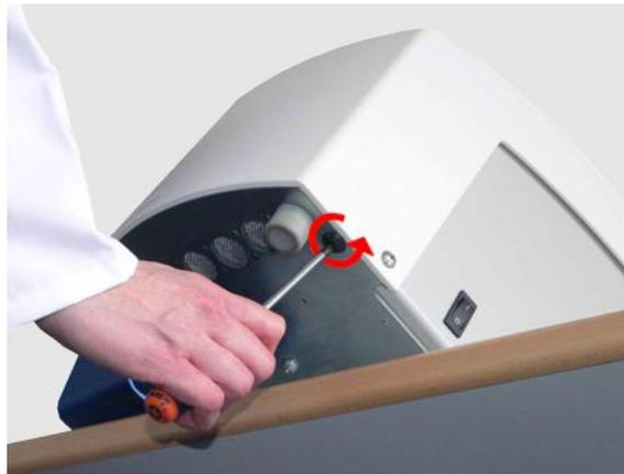
Abb. 35: Lösen der Kreuzschlitzschraube
