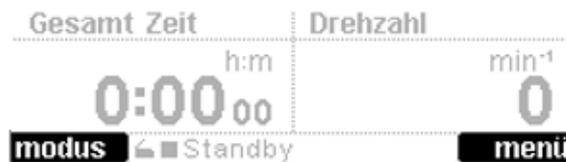
Abb. 17: Anzeige der Belegung der Funktionstasten; hier links die Funktion „modus“, rechts die Funktion „menü“
