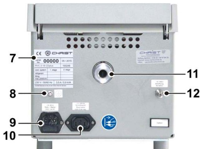
Abb. 48: Rückseite des Rotations-Vakuum-Konzentrators 2-18CDplus
