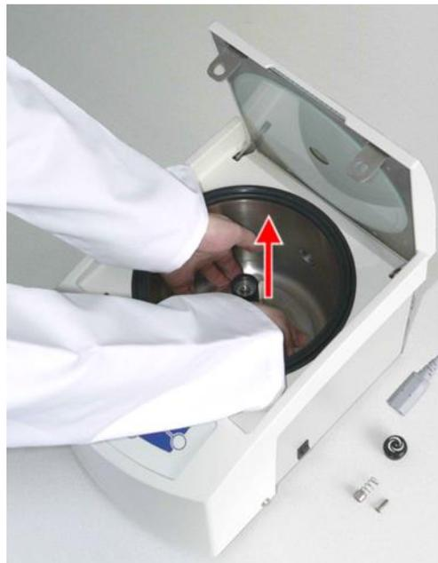
Abb. 44: Abziehen der Rotoraufnahme
