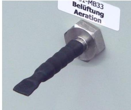
Abb. 4: Schlauchtülle des Belüftungsventils mit Schrumpfschlauch
